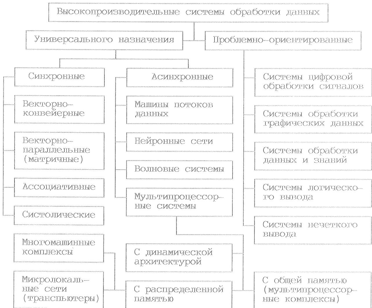
Рис. 1.6. Высокопроизводительные системы обработки данных
