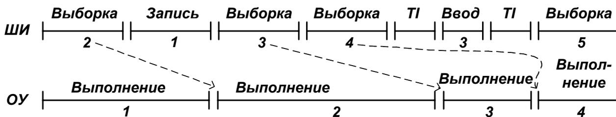
Рис. 2.23. Пример конвейерного выполнения команд
