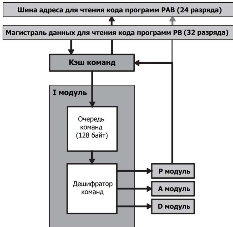
Рисунок 2.1 – Кэш команд и буфер команд
