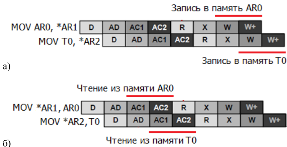
Рисунок 2.9 – Конфликты типа «одновременный доступ к памяти»
