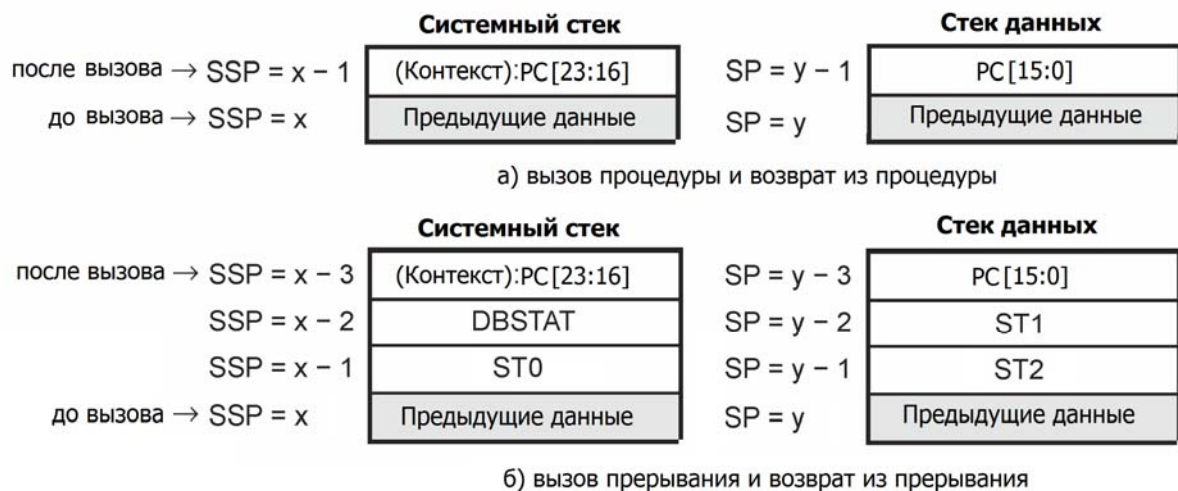
Рисунок 1.34 – Состояние стеков при медленном вызове и возврате
